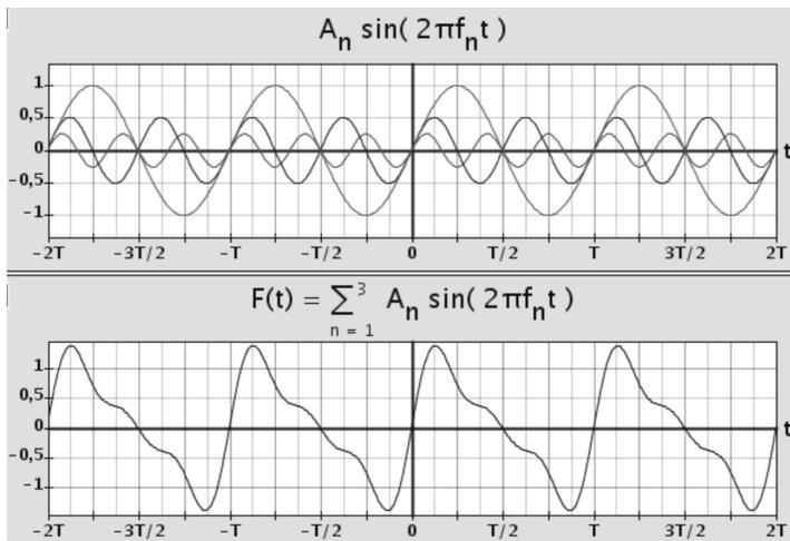
**Figura I:** Síntese dos três harmônicos utilizando o “Making Waves”.
