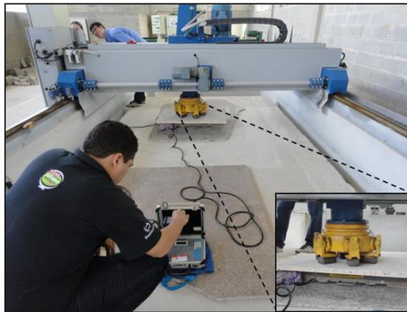
**Figura 4.** Procedimento de calibração das pressões de carregamento.
