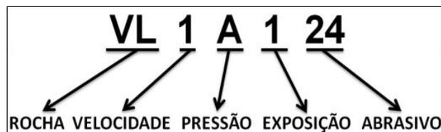
**Legenda:** VL - rocha Verde Labrador; Velocidade de rotação do satélite em rpm (1=300; 2=400; 3=500; 4=600rpm); Pressão de carregamento do satélite em kgf/cm<sup>2</sup> (A=1; B=2 kgf/cm<sup>2</sup>); Exposição do satélite sobre a rocha (percursos 1; 2; 3); Abrasivos (mesh): 24; 36; 60; 120; 220; 400; 600; 800; 1200 e Lustró.
