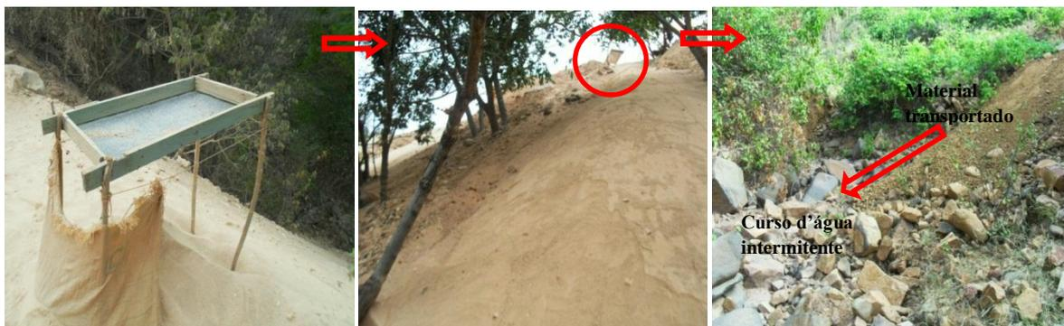
**Fotografia 12.** Local de beneficiamento e transporte de material no Garimpo Boi Morto e assoreamento de curso d'água intermitente.
