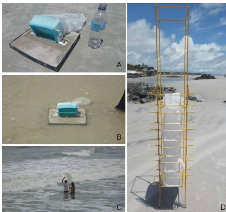
**Figura 3.** Armadilhas portáteis de coleta de sedimentos. Vista frontal do *trap* de espraiamento (A). Experimentação com *trap* de espraiamento na praia do Farol Velho (B) e com *traps* portáteis na zona de *surf* da praia do Atalaia (C). Suporte com *traps* da zona de *surf*, vista frontal (D). Fotografias retiradas em 28/04/2013.
