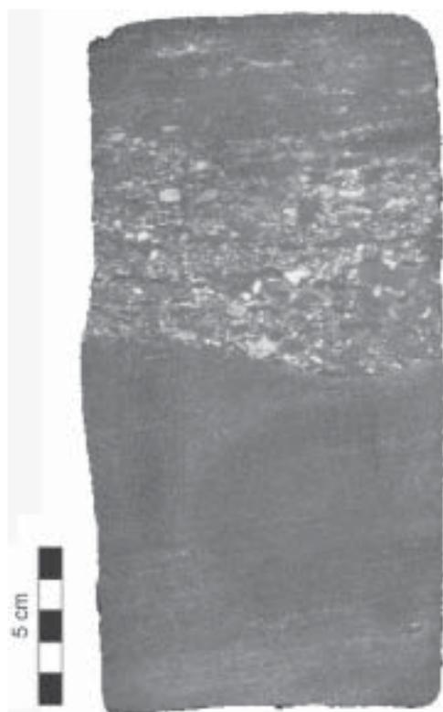
**FIGURA 4.** Formação Caiuá. Contato erosivo entre conglomerado com clastos de argila alongados e clastos de arenito cimentado, e arenito com lâminas de areia fina a média, com estratificação cruzada (~15°). Intervalo 231 a 240 m.
