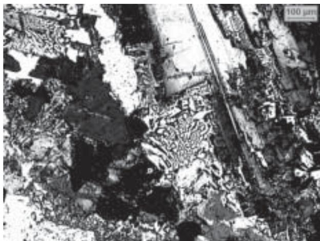
**FOTO 6.** Fotomicrografia de diabásio coletado em dique próximo a Rio Claro, exibindo textura micrográfica, com material de composição quartzo-feldspática no centro da foto (cor branca). Ocorrem também minerais opacos (cor preta), mesóstase microgranular (cor cinza) e cristais prismáticos de plagioclásio (cor branca). Nicóis cruzados.
