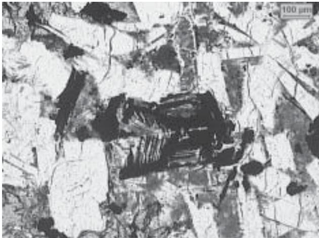
**FOTO 8.** Fotomicrografia de amostra de diabásio de um dique próximo a Ipeúna, com textura intergranular (plagioclásio de cor branca e piroxênio acinzentado), e cristais de minerais opacos (cor preta), retangulares e com aspecto esquelético (centro da foto). Nicóis paralelos.
