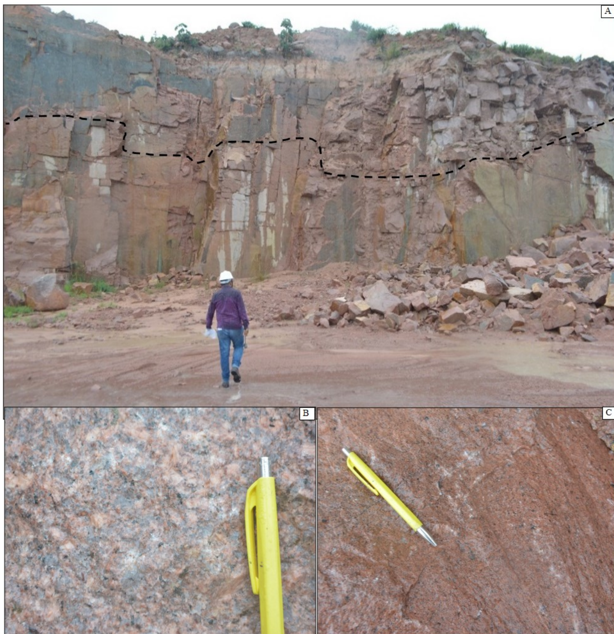
Figura 4 – A) Vista frontal de pedreira produtora de agregados do ponto de coleta A, em que se demonstra a diferenciação do maciço, divididas pela linha tracejada, acima a granulação média e abaixo porfirítica; B) bloco de rocha que representa a amostra A-1 – Sienogranito Porfirítico; C) bloco de rocha que representa a amostra A-2 – Sienogranito Médio a Grosso.
