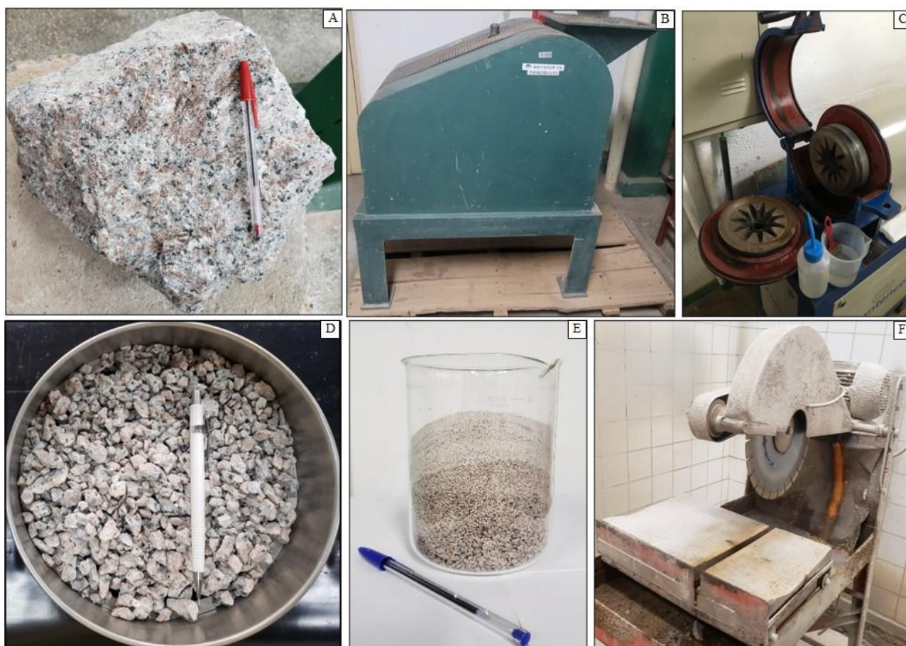
Figura 3 – Redução dos blocos de rocha para ensaio de determinação da Reatividade Álcali Agregado. (a) Bloco de rocha amostrado; (b) Moinho de mandíbulas; (c) Moinho de discos e acessórios para limpeza interna; (d) Aspecto da rocha após processo de moagem em britador de mandíbulas e classificação granulométrica, passante na peneira 19 mm; (e) Aspecto da rocha após processo de moagem em moinho de discos e classificação granulométrica passante na peneira 4,8 mm e subsequentes; (f) Equipamento dotado de disco diamantado para confecção das lâminas delgadas.
