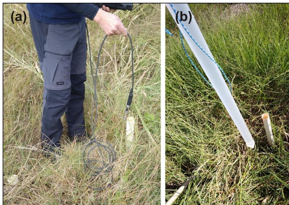
**Figura 4** - a) Equipamento de mensuração *in situ* dos parâmetros físicos e químicos. b) Amostrador bailer contendo amostra de água retirada do poço durante a campanha.
