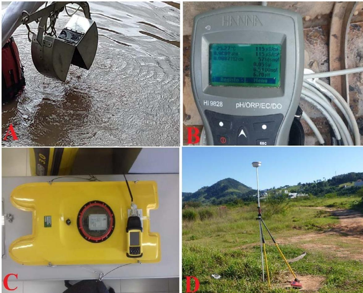
**Figura 8** – Equipamentos utilizados no trabalho de campo: A) Amostrador do tipo Van Veen; B). Sonda multiparâmetro Hanna HI9828; C) Medidor de vazão Qliner V3 e; D) Receptor GNSS Leica LI e L2.
