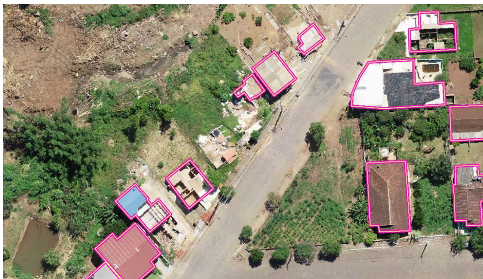
Figura 2 – Ilustração do ortomosaico em um segmento urbano de Roca Sales-RS severamente atingido pela inundação em 2024 e restituição manual das edificações.
