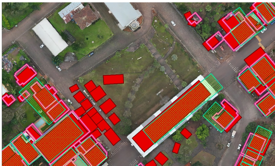
Figura 7a – Demonstração do algoritmo com o índice de Jaccard nas feições OSM e Open Buildings V3.
