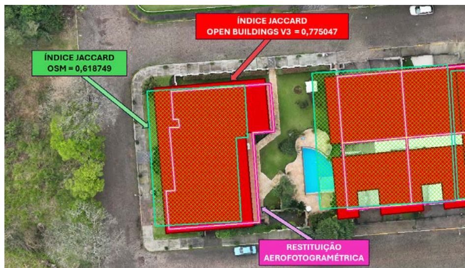
Figura 6 – Demonstração do algoritmo com o índice de Jaccard nas feições OSM e Open Buildings V3.
