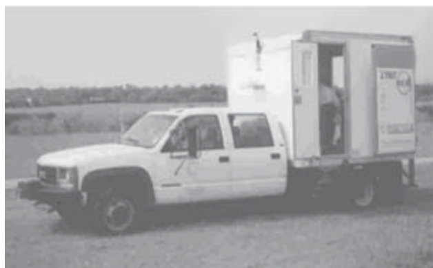
FIGURA 4. Equipamento CIMCPT montado em veículo na Louisiana State University.
