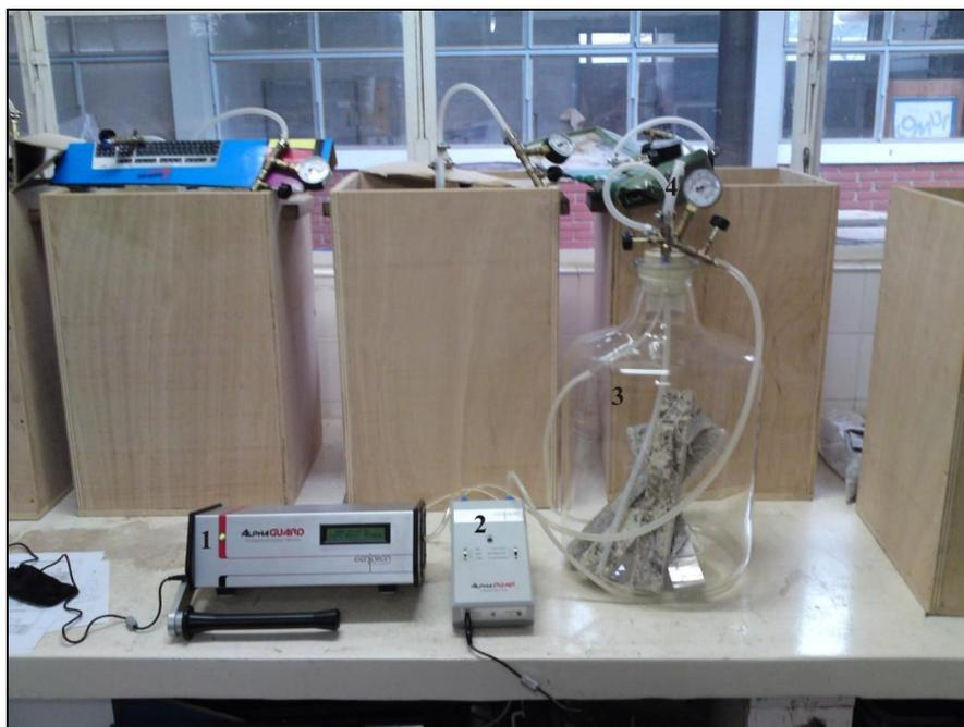
**Figura 1.** Foto do sistema usado para medir a exalação do gás radônio nas amostras estudadas. (1) espectrômetro alfa; (2) bomba de ar; (3) garrafa e (4) sistemas de válvulas.
