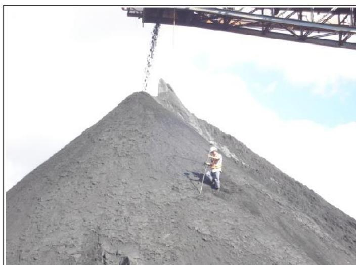
**Figura 01** - Levantamento GPS para cálculo de volume de minério.
