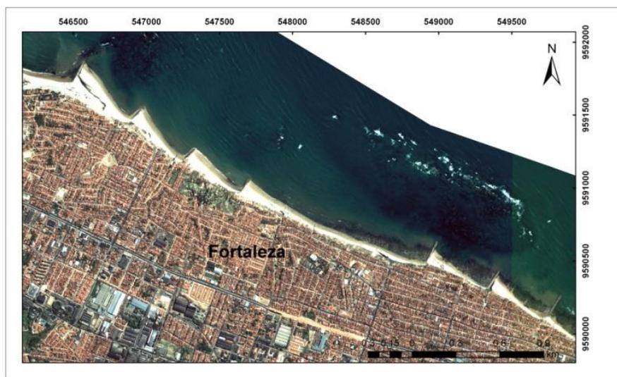
**Figura 19.** Molhes costeiros instalados ao longo da Enseada do Mucuripe para conter a erosão produzida pela interceptação de sedimentos a barlar da Ponta do Mucuripe, a qual foi largamente ampliada pelo Porto do Mucuripe (Imagem *QuickBird*).
