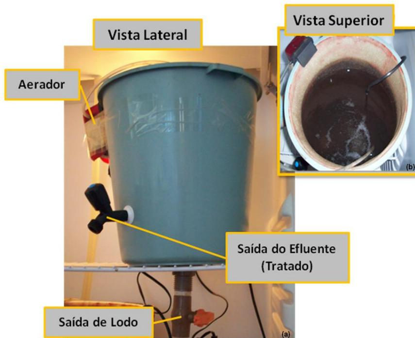
**Figura 1:** Reator RBS: a) vista lateral do reator com aerador, registros de descarte do efluente e lodo; b) vista superior do reator com espuma de poliuretano para imobilização da biomassa. Fotografia: adaptado de Andrade (2008).
