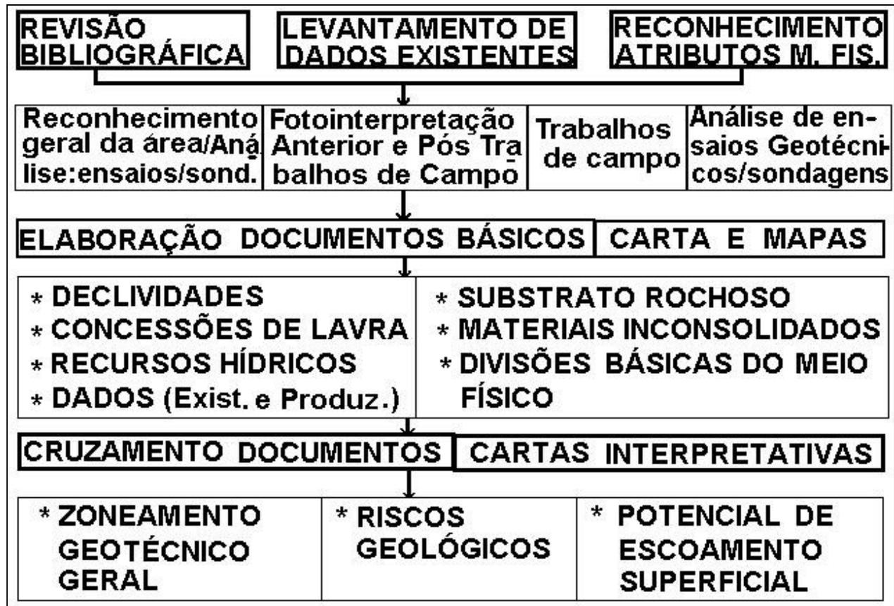
Figura 1. Procedimentos e Metodologias adotados para o desenvolvimento dos trabalhos de Mapeamento Geotécnico.
